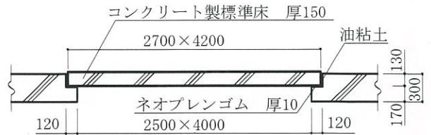
【コンクリート製標準床および支持部断面図】
